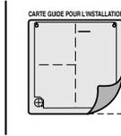
Faites une perforation d'un diamètre de 6mm et d'une profondeur de 30-35mm en perçant l'un des points destinés aux vis.
