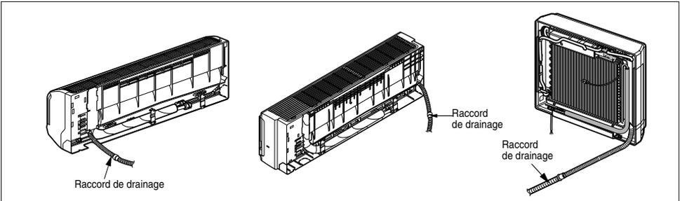
2. Collez la tuyauterie, le raccord de drainage et le câble de raccordement à l'aide du ruban adhésif. Assurez-vous que le raccord de drainage est placé dans la partie inférieure du faisceau. Le placer dans la partie supérieure peut provoquer le débordement de l'eau du bac à condensats à l'intérieur de l'unité.
