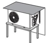
1. L'hauteur du cadre H doit être supérieure de 2 fois la neige tombée et sa largeur ne doit pas dépasser la largeur du produit. (Si la largeur du cadre dépasse celle du produit, la neige s'entassera là)
