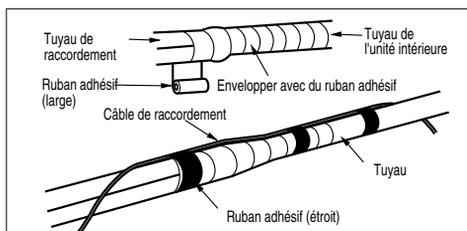
3. Reliez la tuyauterie et le raccord de drainage avec du ruban adhésif de telle sorte qu'ils puissent s'encastrer dans la zone de la tuyauterie arrière.
