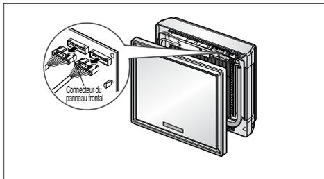
3. Accrochez le crochet du panneau frontal dans la rainure puis resserrez les 2 vis.
