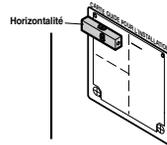
Faites un trou de Ø65mm de diamètre sur la pièce à percer, pour y insérer le tuyau de raccordement (en cas de percer la surface inférieure).
