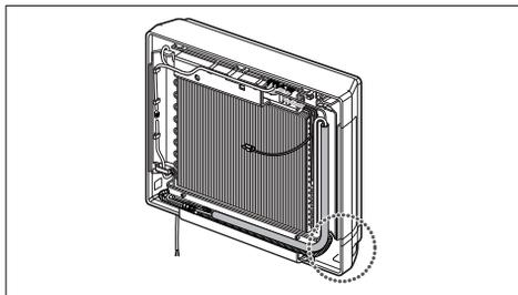
2. Assemblez le fil de raccordement avec le régulateur et d'abord fixez la partie supérieure du panneau frontal, puis accouplez la partie inférieure du panneau frontal.
