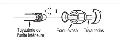
2. Serrez l'écrou évasé à l'aide d'une clé.
