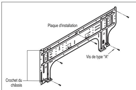
2. Mesurez le mur et marquez la ligne de repère centrale. Soyez vigilant également dans le choix de l'emplacement de la plaque d'installation. L'acheminement des câbles se fait généralement à travers les murs. Prenez donc les précautions nécessaires lorsque vous percez le trou de fixation.
