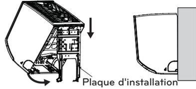
2 Débloquez la patte de retenue du châssis et insérez-la entre le châssis et la plaque d'installation afin de séparer du mur la partie basse de l'unité intérieure.
