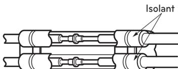
2 Enveloppez la zone de raccordement à l'arrière des tuyauteries avec du ruban vinyle.
