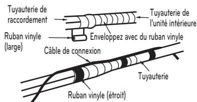
3 Regroupez les tuyauteries et le flexible d'évacuation en les enveloppant à l'aide de ruban vinyle sur toute la longueur de leur raccordement à l'arrière de l'unité.
