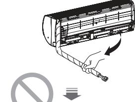
2 Débouchez la patte de retenue du châssis et insérez-la entre le châssis et la plaque d'installation afin de séparer du mur la partie de l'unité intérieure.
