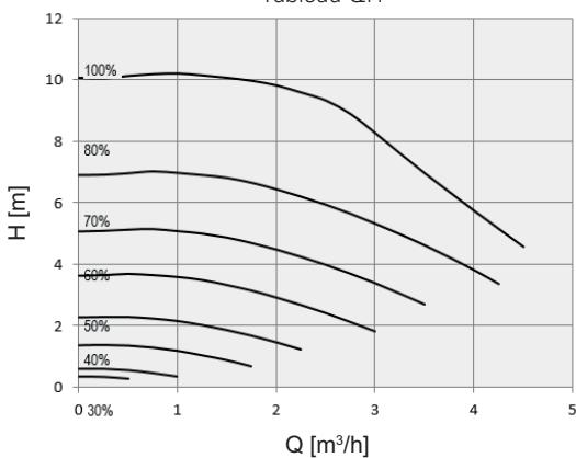
Le test de performance est basé sur la norme ISO 9906 avec une pression de 2.0 bars et une température liquide de 20 °C.
