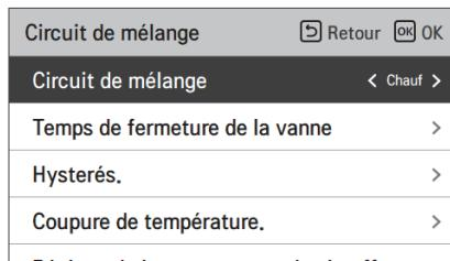
Vous pouvez régler vous-même le temps de fermeture de la vanne [sec] et la température d'hystérésis [°C] sur l'écran. Le réglage de la température de coupe empêche l'eau de dépasser la température de coupe dans le circuit de mélange pendant le fonctionnement du chauffage.
