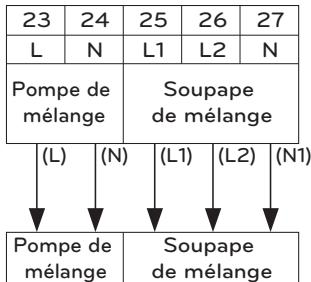
(L) : Signal en direct de PCB pour la pompe de mélange.
