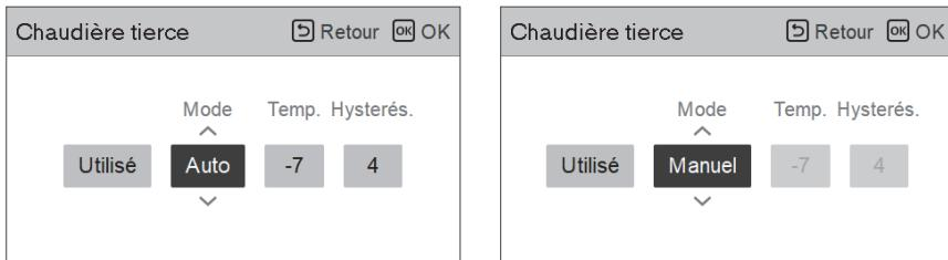
Si le mode de cette fonction est réglé sur « Auto », vous pouvez régler la température de la chaudière et l'hystérésis, respectivement.
