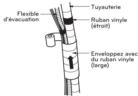
Pour le montage de la tuyauterie, enveloppez le câble de connexion et la tuyauterie frigorifique (entre l'unité intérieure et l'unité extérieure) avec un isolant thermique et fixez-le à l'aide de deux types de ruban vinyle.
