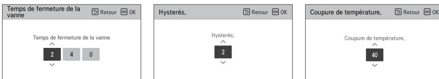
Fonction de réglage de l'installateur pour régler le fonctionnement de la pompe de mélange d'eau / l'option de temps de retard en mode chauffage / refroidissement
