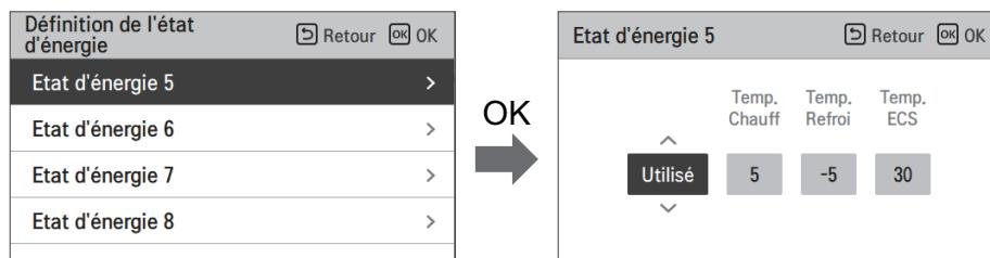
Lorsque le mode signal du type d'utilisation EES est sélectionné, appuyez sur le bouton d'assignation d'entrée numérique pour définir l'état d'énergie en fonction du signal d'entrée
